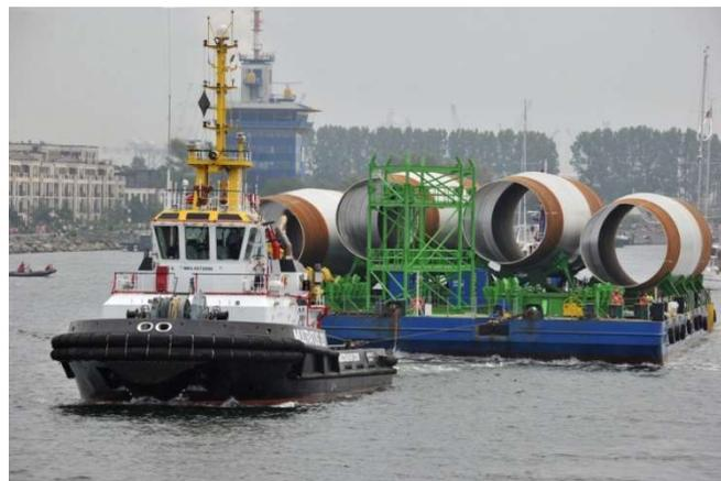
Schlepper „MULTRATUG 20“ mit Ponton von Windradteilen
