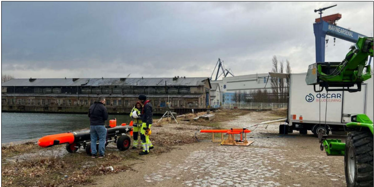
Abbildung 2: UUV Seacat (links) und Mag-Wing mit 3-Achs-Magnetiksensoren (mittig)
