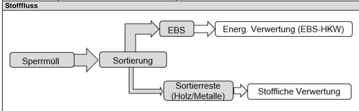
**Bilanzierungsgrenzen** Sammelverkehr (Quelle: SR), stoffliche Verwertung Eisen-/Nichteisenmetalle/Holz (Belastung und Gutschrift), energetische Verwertung EBS (Belastung: Betrieb und Behandlung EBS-HKW, Gutschrift: Strom und Wärme, über die Menge erzeugter Energie standen keine Daten zur Verfügung, es besteht eine erhebliche Unsicherheit im Ergebnis der Bilanz)
