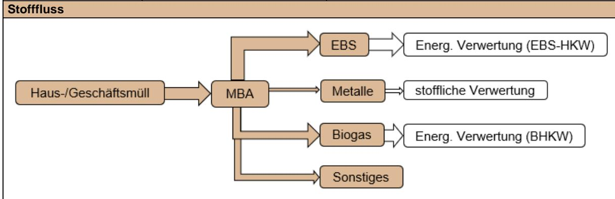
**Bilanzierungsgrenzen** Sammelverkehr (Quelle: SR); Entsorgungsverkehr: (Quelle: Veolia); Mechanisch-Biologische-Abfallbehandlung (MBA, Quelle: Veolia), energetische Verwertung Ersatzbrennstoff (Belastung: Verbrennung, Gutschrift: Strom/Wärme), energetische Verwertung Biogas (Gutschrift: Strom/Gas), stoffliche Verwertung Eisen-/Nichteisenmetalle (Belastung und Gutschrift)
