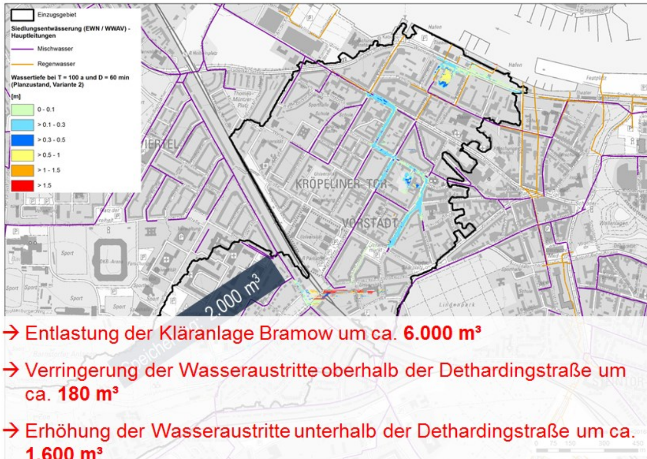
Abbildung 4-22: Aus dem Leitungssystem austretende (1D) und oberirdisch abfließende (2D) Wassermengen, Regenereignis T = 100 a und D = 60 min
