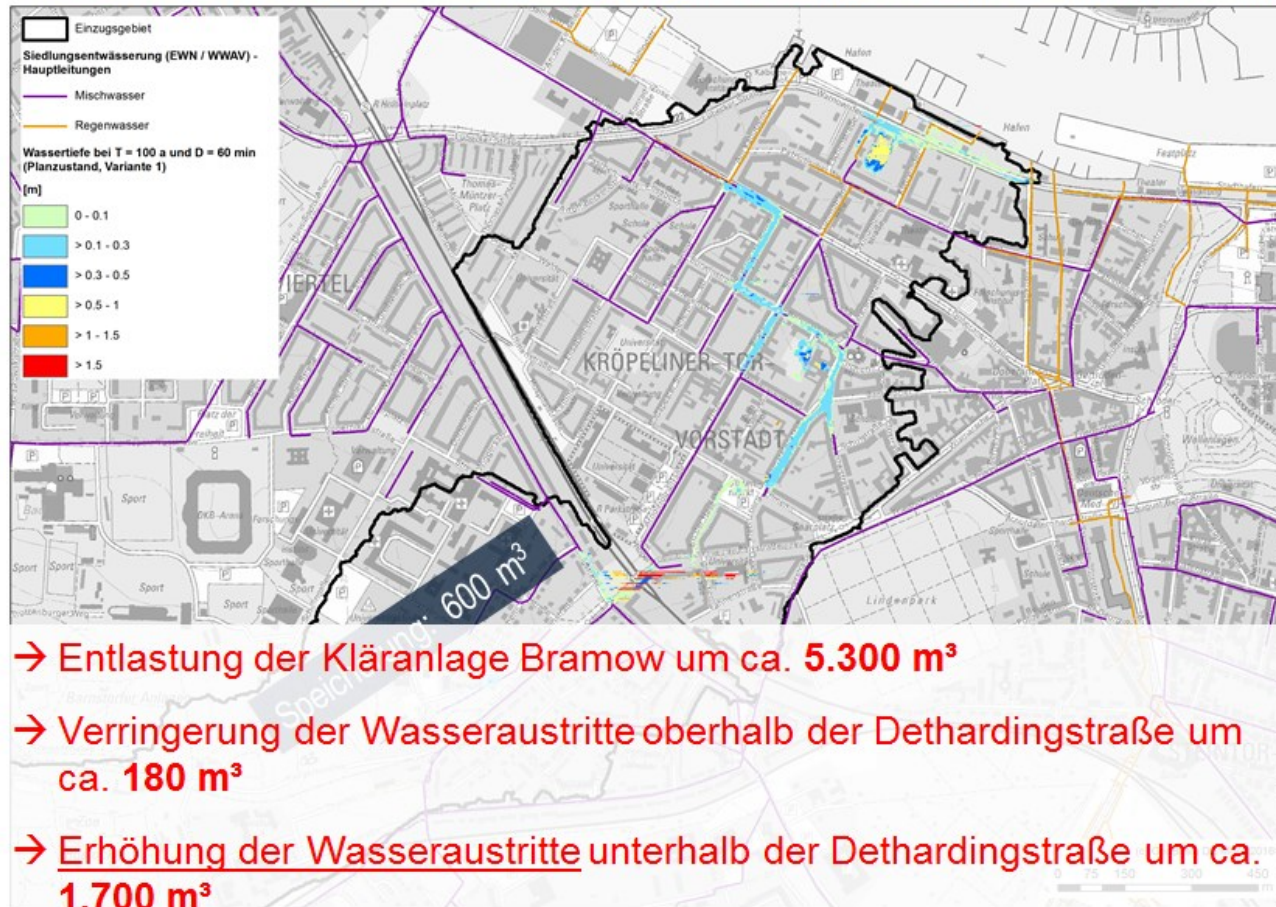
Abbildung 4-20: Aus dem Leitungssystem austretende (1D) und oberirdisch abfließende (2D) Wassermengen, Regenereignis T = 100 a und D = 60 min
