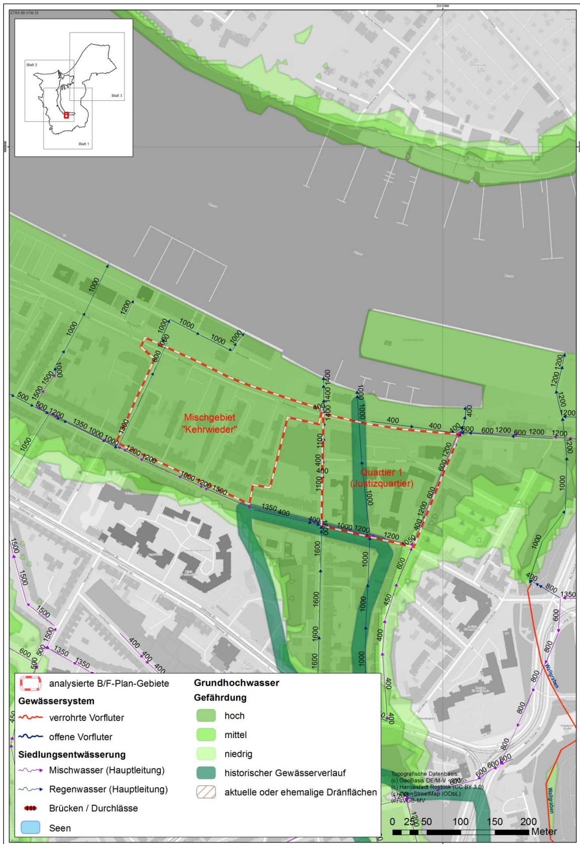
Abbildung 6-12: Gefährdung durch Grundhochwasser, historische Gewässerverläufe und Dräne in den B-Plan-Gebieten „Kehrwieder“ und „Quartier 1 (Justizquartier)“
