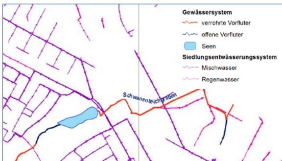
Abbildung 5-1: Ausschnitt aus dem urbanen Entwässerungssystem
