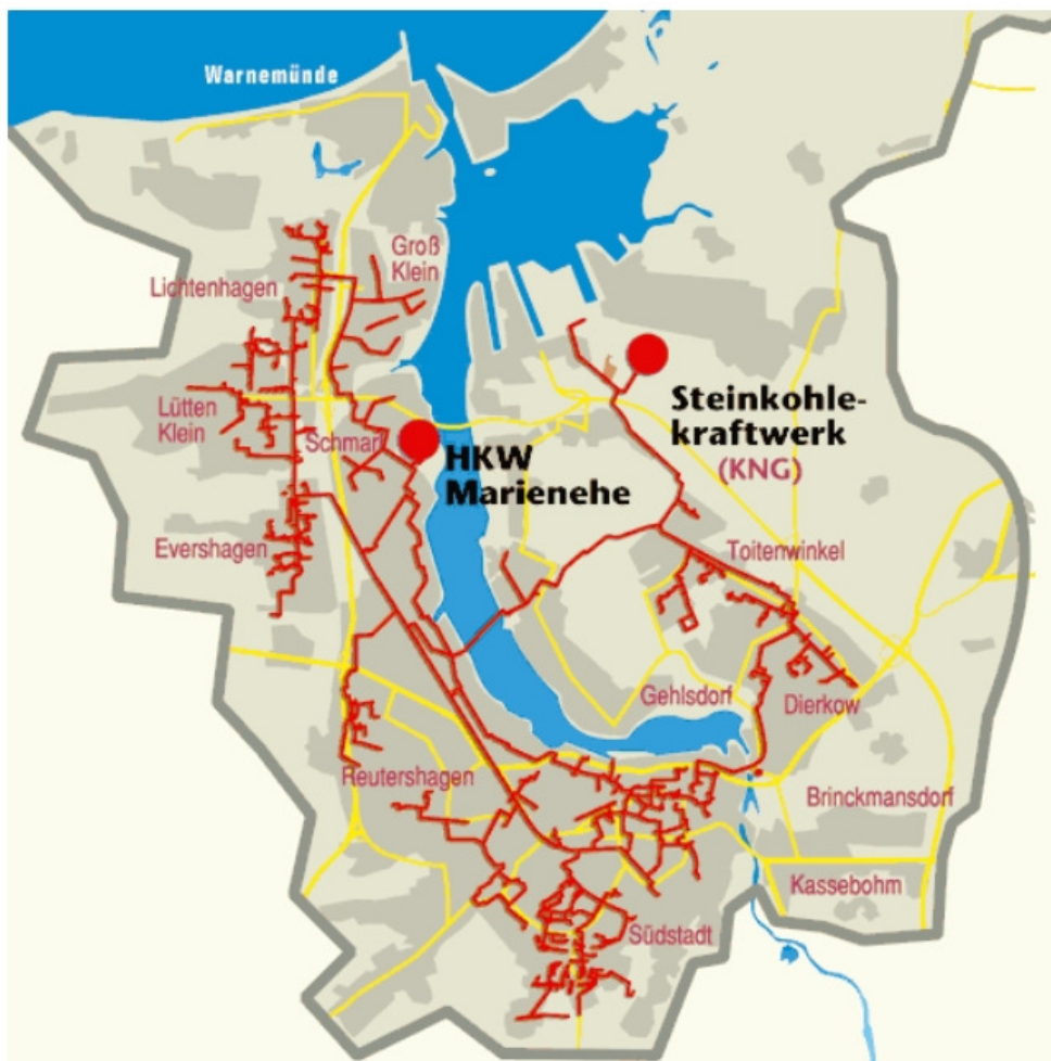
Abbildung 4: Versorgungsgebiet Fernwärme Rostock (Stand ca. 2010) /7/
