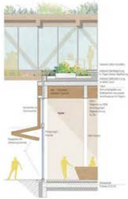
Detailschnitt Fassade M 1:50
