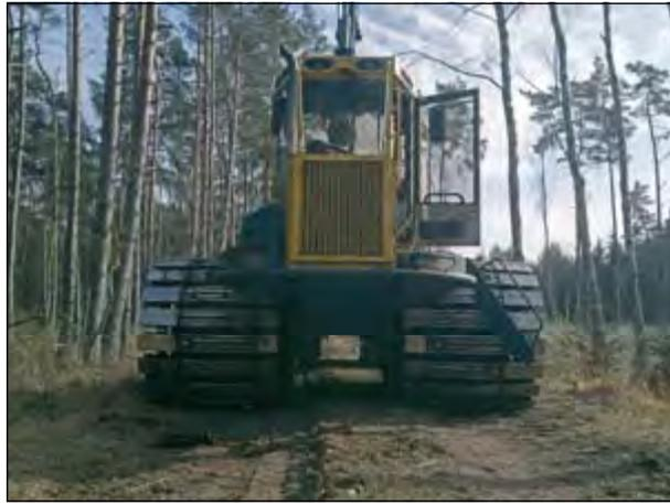
Abb. 15: Rückezug mit extrabreiten Reifen und 1,35 m Moorbändern für bodenschonende Holzbringung auf Nassstandorten
