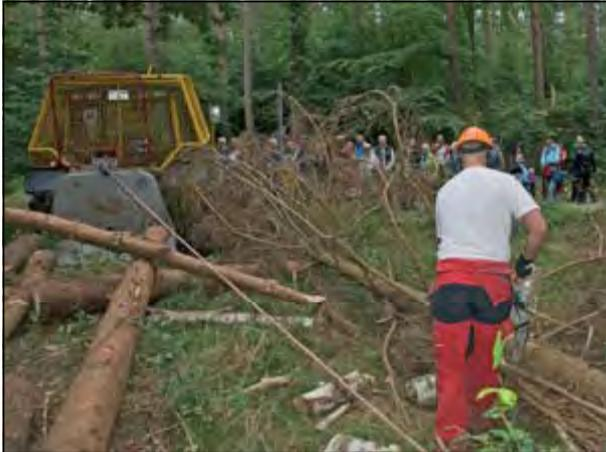
Abb. 54: Demonstration der motormanuellen Sturmholzaufbereitung mit neuer, kunststoffseilbestückter Dreipunktbauwinde (Foto: Eisenack)
