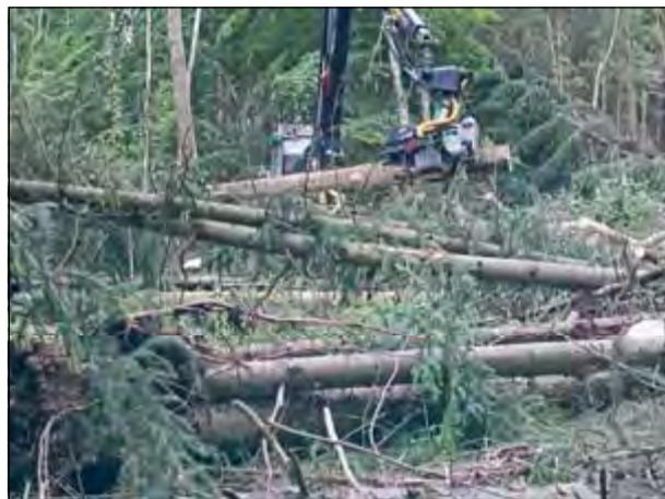
Abb. 20: Sturmholzaufbereitung mit Harvester
