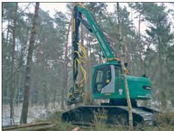
Abb. 14: Sanitärtrieb auf mit normalem Harvester auch mit Moorbändern nicht befahrbarem Nassstandort – das überbreite, verlängerte Raupenfahrwerk senkt den Bodendruck
