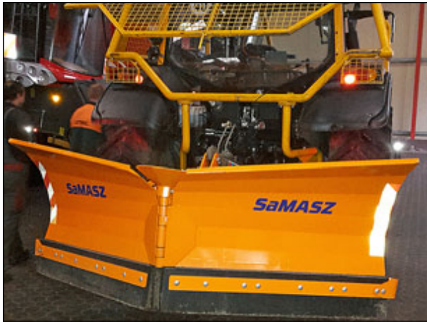
Abb. 65: Endlich wurde auch ein waldaugliches Räumschild für den Heckanbau gefunden, um Hof und Hauptwege von Schnee zu befreien.
