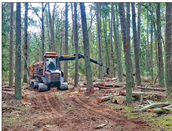
Abb. 25: Raupenforwader im Einsatz
