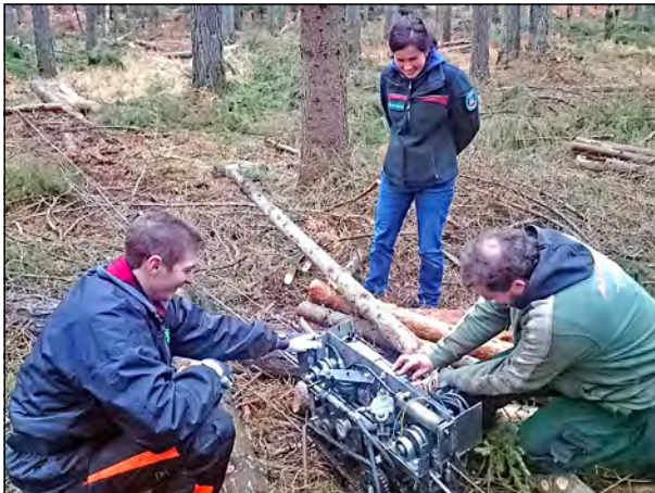
Abb. 49: Seilkran-Projekt: Test der Laufkatze
