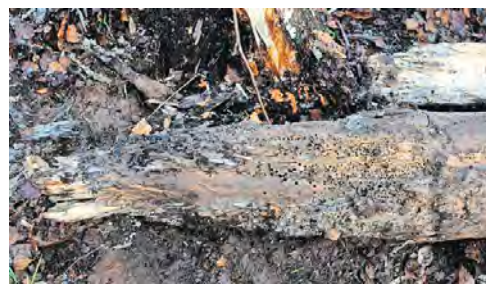
Der Schiffsbohrwurm hat die bis zu 70 Jahre alten Kiefern zerfressen.
