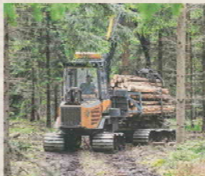
Mit einem so genannten Forwarder wird Holz transportiert.
