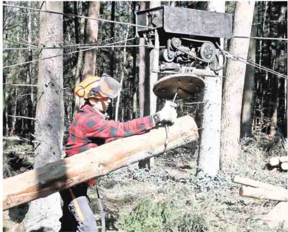
Forstwart Marc Hinz hängt einen gefällten Stamm an die Laufkatze.
