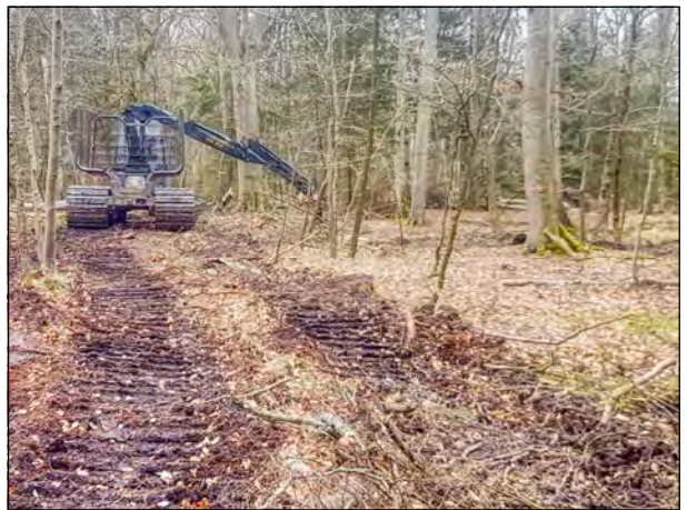
Abb. 22: Auch sog. Moorbänder ermöglichen einen bodenschonenden Technikeinsatz (hier: Forwarder im Laubholz)
