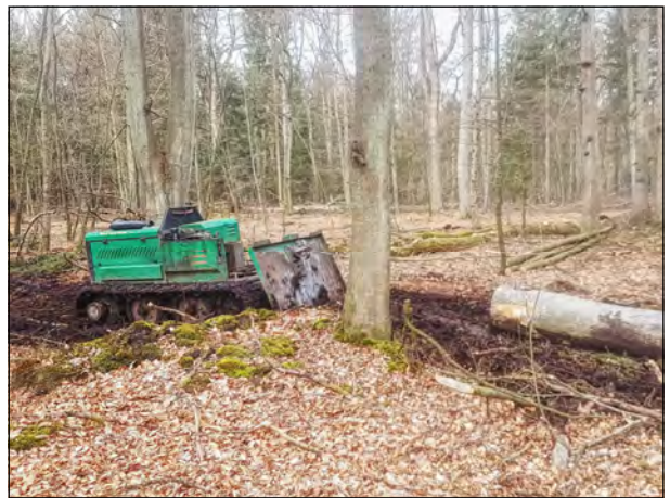
Abb. 21: Miniraupe beim bodenschonenden Rücken von Stammholz
