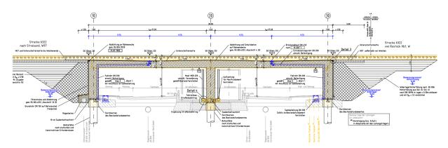
Der Südring unterquert jeweils mit zwei Richtungsfahrbahnen sowie Geh- und Radwegen das Bauwerk. In jedem Brückenfeld ist im Straßenbereich jeweils ein Regenwasserkanal DN 800 vorhanden. Im Bestand ist der Anschluss der Brückenentwässerung an die beiden Regenwasserkanäle erfolgt. Dieser Zustand wird im Rahmen des Ersatzneubaus nicht verändert. Es erfolgt jeweils ein Anschluss an die Regenwasserkanäle vor und hinter dem Bauwerk.
