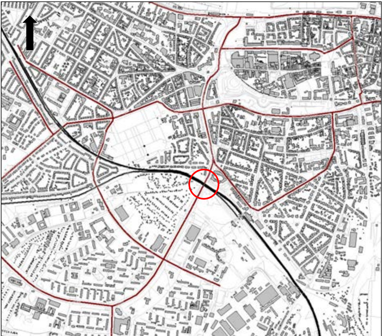
Abbildung 6: Überblick über die berücksichtigten Emissionsquellen für die Betrachtung der Lärmvorbelastung; Schienenverkehr (schwarz); Straßenverkehr (rot).
