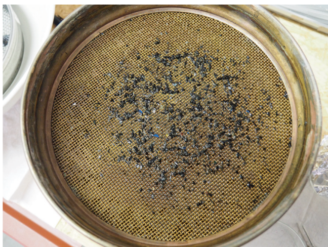
Abb 1.: Aus Sediment des Alten Stroms (Fluss Warnow, Warnemünde) isolierte Partikel \geq 0,5\text{ mm} . Gut zu erkennen sind insbesondere blaue Farbpartikel, welche meist von Bootsanstrichen stammen.
