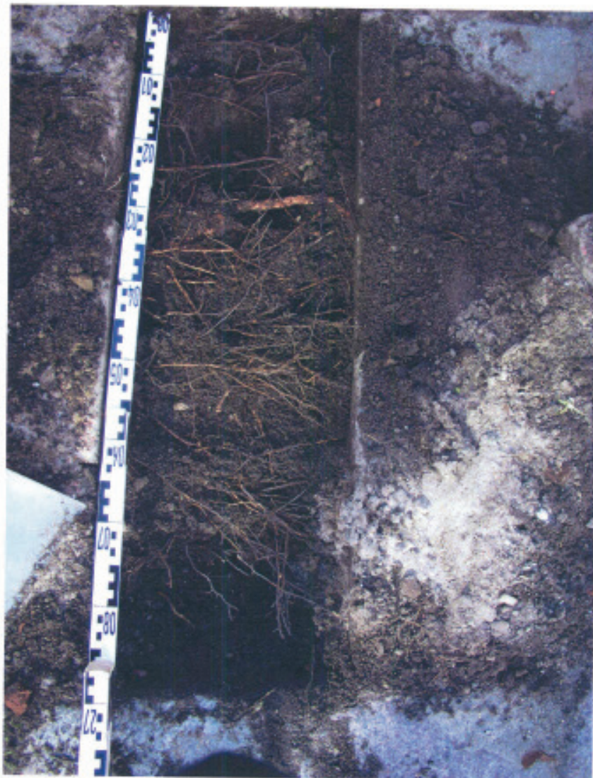
Abb. 3: Suchgrabung im Gehweg in ca. 1,5 m Abstand zum Baum
