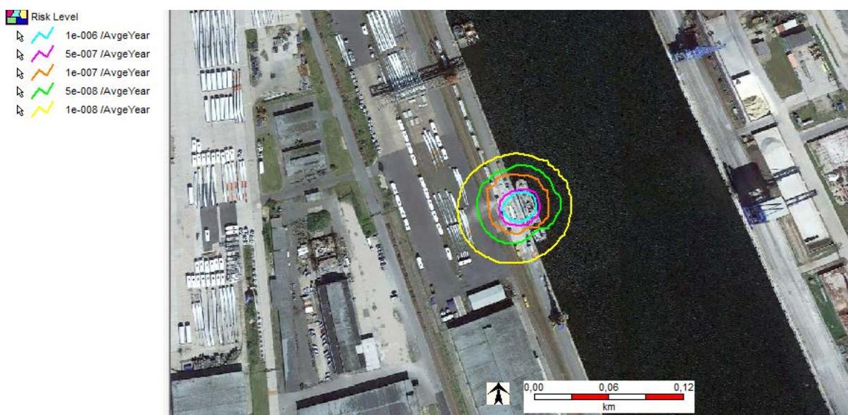
Abbildung 31: Risikokonturen TTS Bebungung mit Schlauch und 5 s ESD
