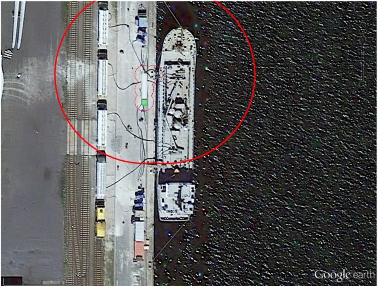
**Abbildung 44: Beispiel Sicherheitsabstände Zementfrachter (Minimalabstände bei zusätzlichen Sicherheitsmaßnahmen als unterbrochene Linie)**
