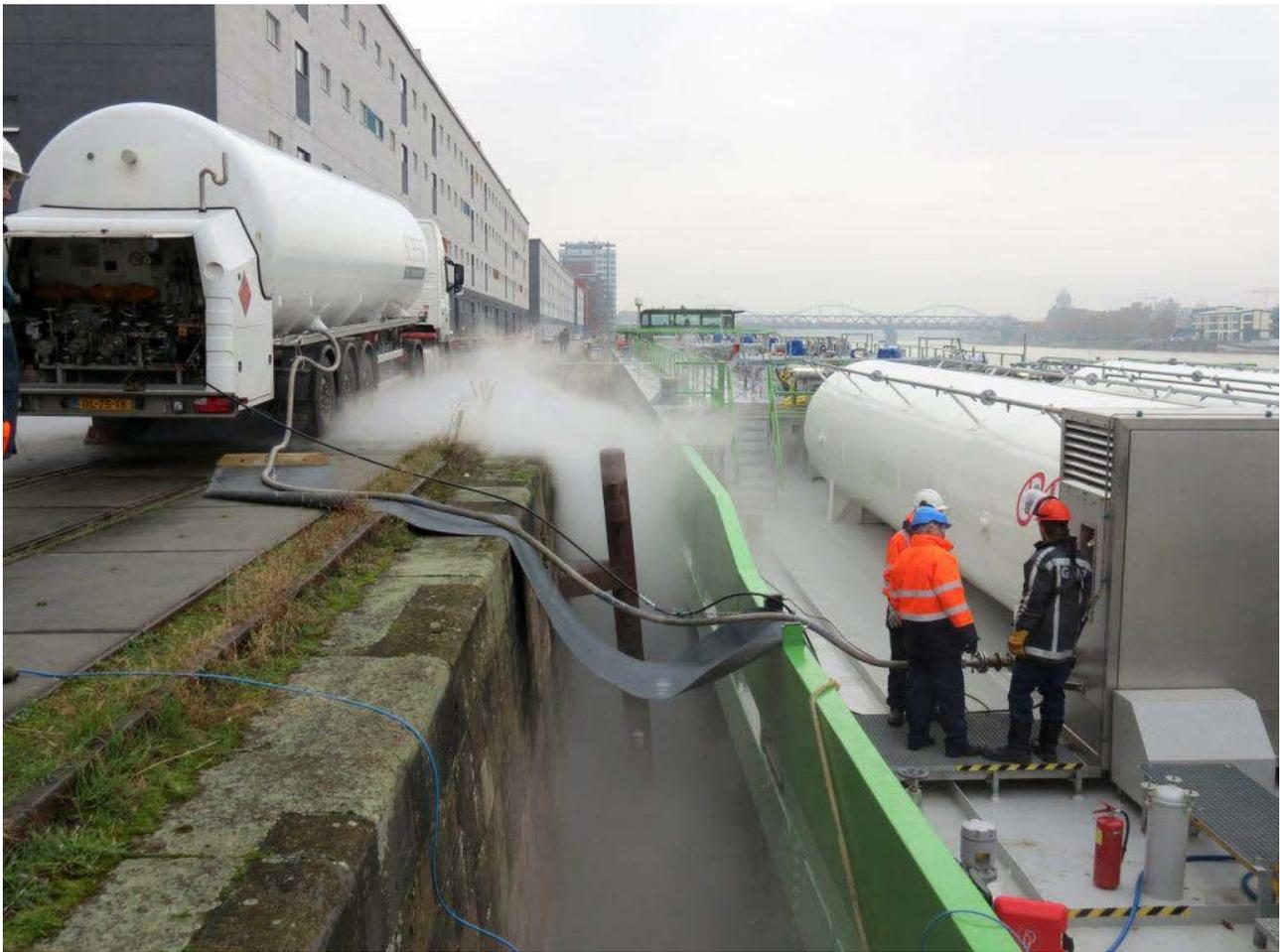
**Abbildung 13: Truck-to-Ship Bebunkerung der GreenStream (Quelle: [www.bonapart.de](http://www.bonapart.de))**
