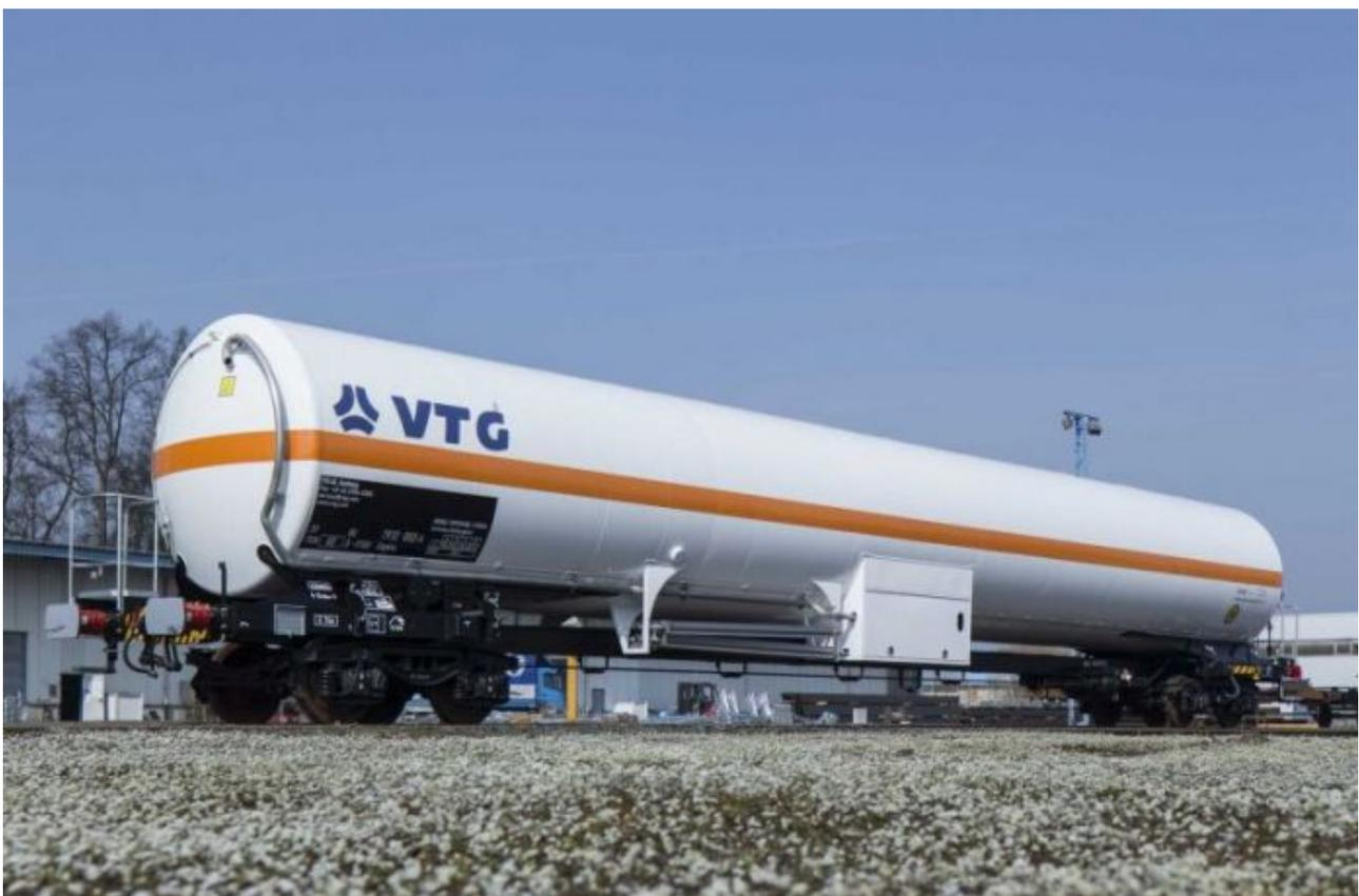
Abbildung 14: Kesselwagen für den Transport von LNG (Quelle: <http://www.business-on.de>)
