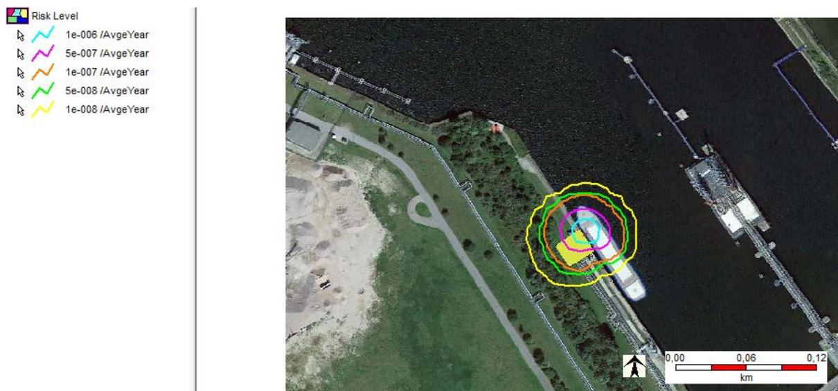
Abbildung 37: Risikokonturen PTS Bebungung mit Ladearm bei 1 barg Differenzdruck
