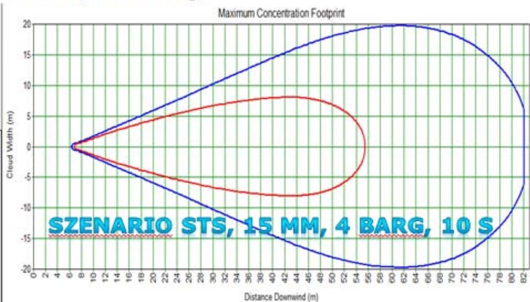
Abbildung 42: Ergebnis Ausbreitungsrechnung STS (Konzentration: rot UEG, blau LEL/2)
