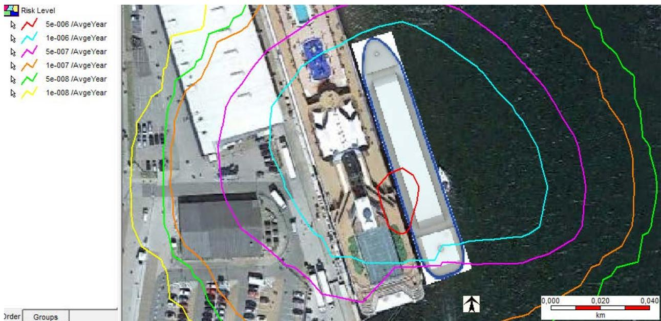
**Abbildung 27: Vergrößerung Risikokonturen STS Bebungung aus Abbildung 24**
