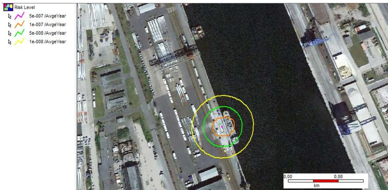
Abbildung 35: Risikokonturen TTS Bebungung mit Ladearm, Nennweiten DN 50
