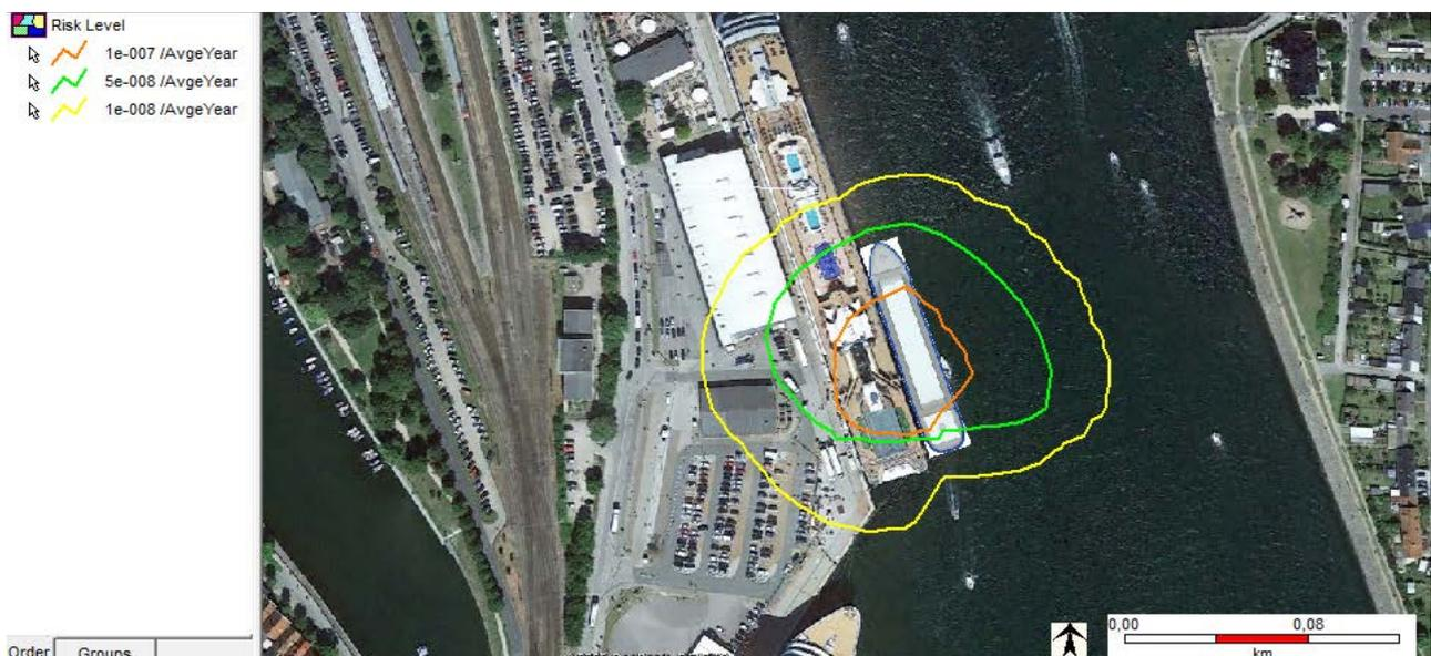
**Abbildung 29: Risikokonturen STS Bebungung mit Ladearm bei 8 barg Differenzdruck**
