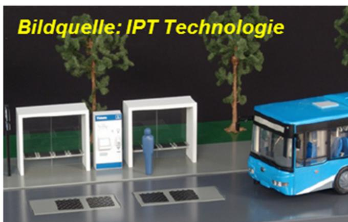
Das induktive Laden bezeichnet einen berührungslosen Ladevorgang. Hier werden in die Fahrbahn Ladepplatten eingelassen. Sobald der Bus die entsprechende Position erreicht hat, kann der Ladevorgang erfolgen. Hersteller dieser Ladetechnik ist u. a. Bombardier.
