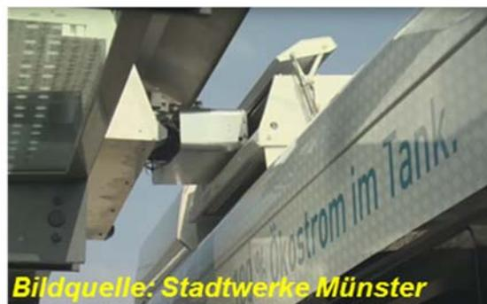
In allen drei Systemen wird der Busfahrer mittels Navigationstechnik über die Position des Busses zur Ladeinfrastruktur informiert, so dass er den Bus korrekt bis zur Ladestelle führen kann. Aufgrund der automatisierten Technik sind alle drei beschriebenen Systeme einfach handhabbar, sicher und erfordern kein spezifisches Können.
