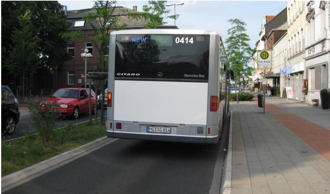
Abbildung 83: Haltestellenkap in Hauptstraße mit Mittelstreifen zur Verhinderung des Überholens (Beispiel: Mönchengladbach)
