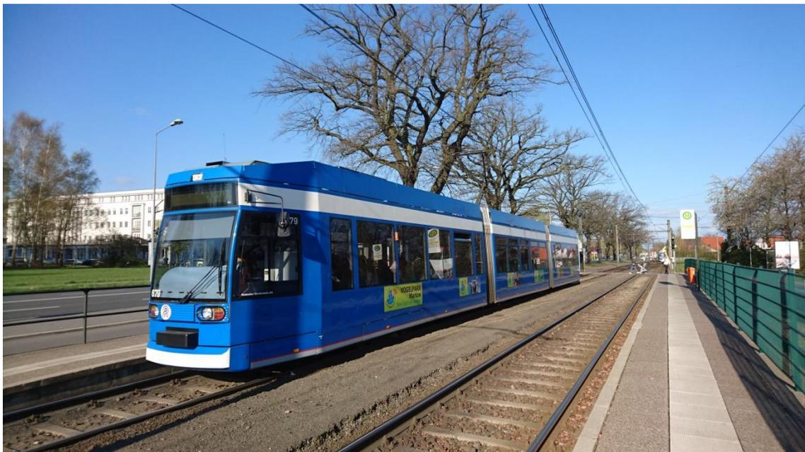
Abbildung 20: Strecken mit besonderen und unabhängigen Bahnkörpern prägen das Rostocker Straßenbahnnetz
