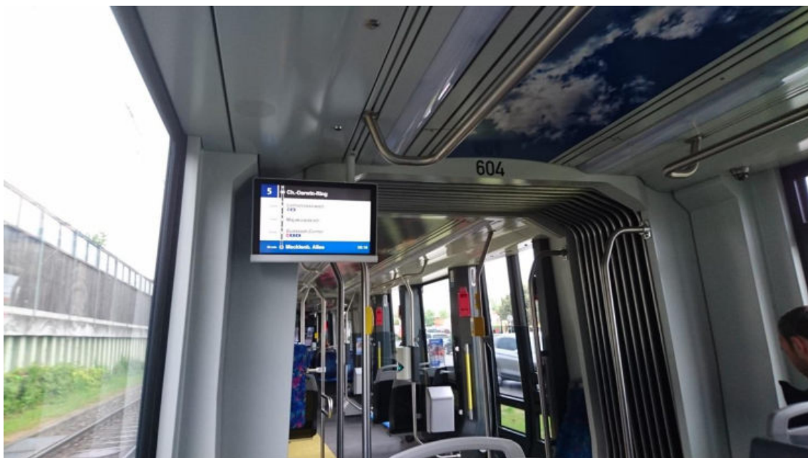
Abbildung 17: Anzeigen mit dynamischer Fahrgastinformation in den Fahrzeugen
