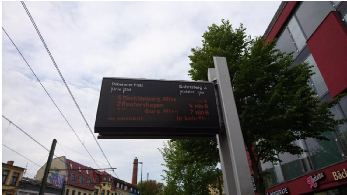
Abbildung 18: Anzeigen mit dynamischer Fahrgastinformation an den Haltestellen
