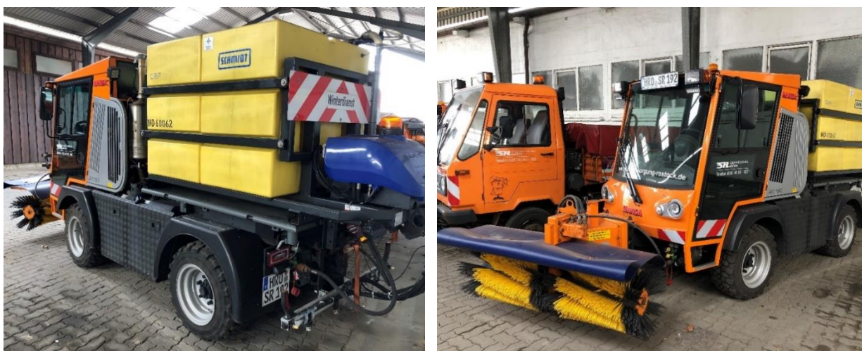
Kleingeräteträger mit Solebehälter und Kehrbesen – in Winterdienstausrüstung (links u. rechts)
