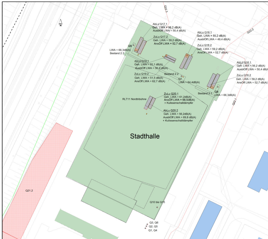
Abb. 6-4: Emissionsquellen für die gebäudetechnischen Anlagen der Stadhalle
