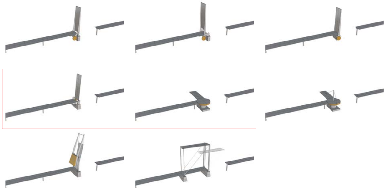
Abbildung 39: Bewegliche Brückenmechanismen mit ausgewählten Vorzugsvarianten
