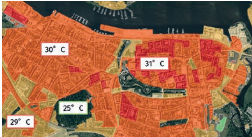
Nächtliche Überwärmung der Siedlungsflächen in der Rostocker Innenstadt im Vergleich zu Grünflächen. Grafik: Geoport, Stadtklimaanalyse HRO, GEO-NET
