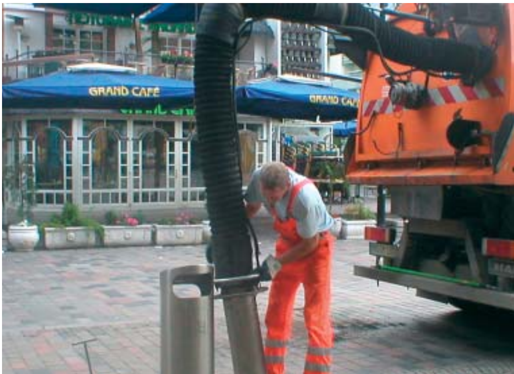
Entleerung eines Unterflur-Abfallbehälters in der Kröpeliner Straße
