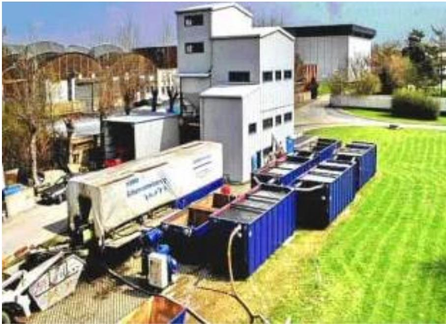
Mobile Kammerfilterpresse im Einsatz (Quelle Sedimenta)
