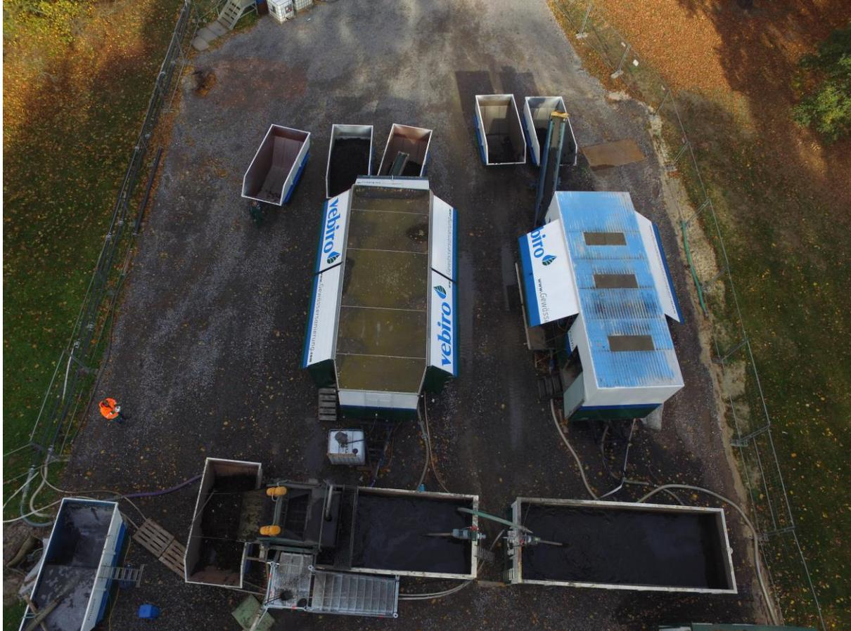
Mobile Schlammaufbereitungsanlage im Einsatz
