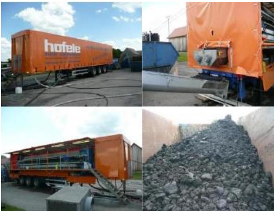
Mobile Kammerfilterpresse im Einsatz (Quelle Hofele)
