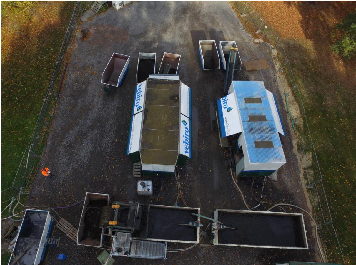
Mobile Schlammaufbereitungsanlage im Einsatz
