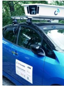
Detail Lidar und Kameras
