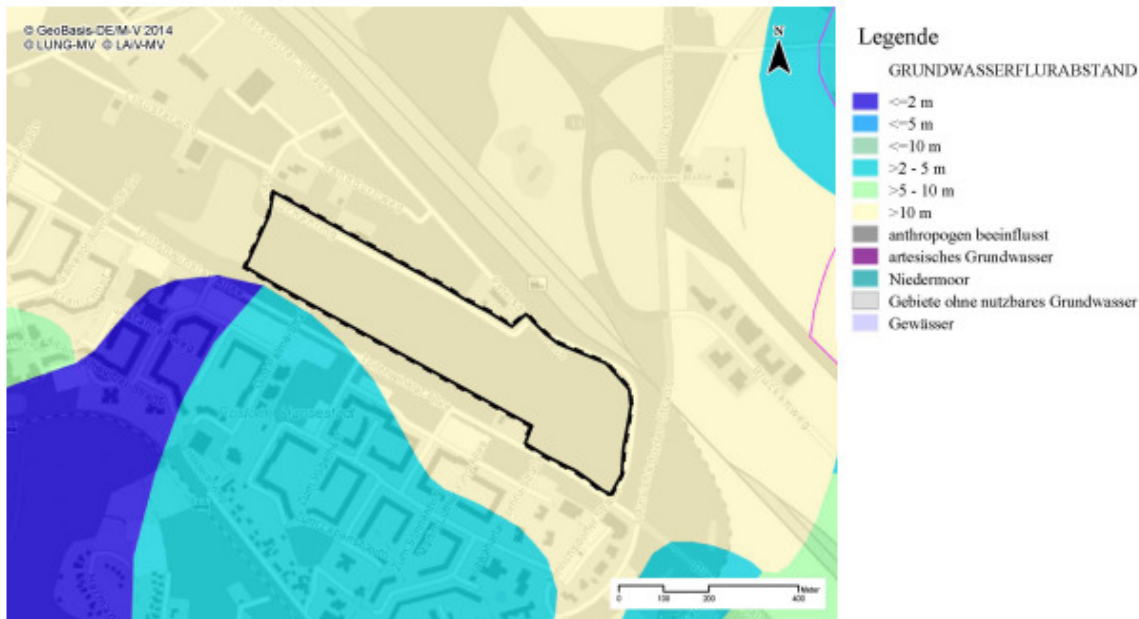
Abbildung: Grundwasserflurabstand im Plangebiet (KPU LUNG-M-V, 2014)
