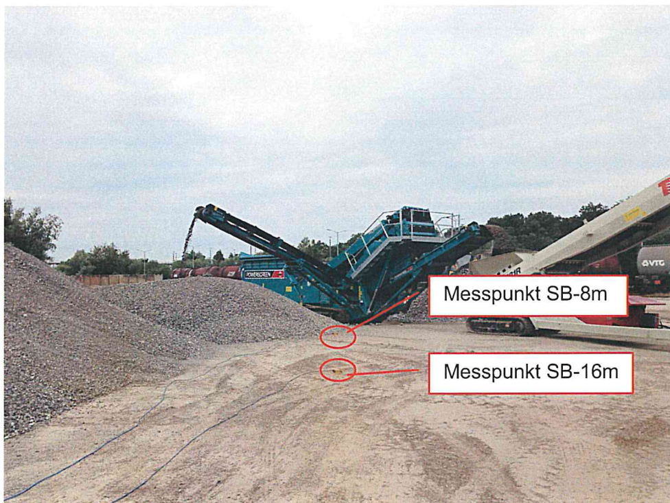
Abbildung 3: Messpunkte SA-8m und SB-16m der Messkette an der Siebanlage
