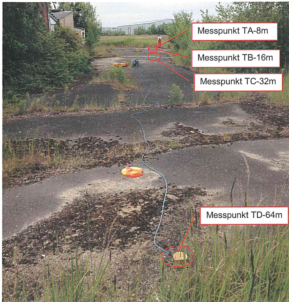
Abbildung 4: Messpunkte der Messkette zur Bestimmung der Transmission im Plangebiet
