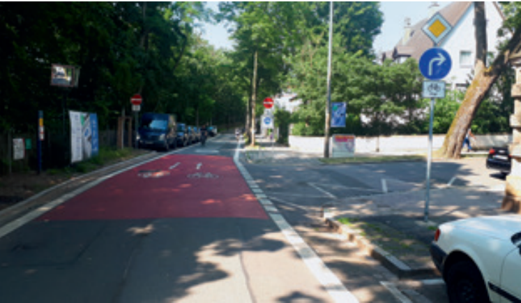
Bild 29: Beispiele für Einbahnstraßen mit Freigabe für den gegenläufigen Radverkehr im Verlauf von Fahrradstraßen (Foto: ©Thiemo Graf/Innovative Städte)
