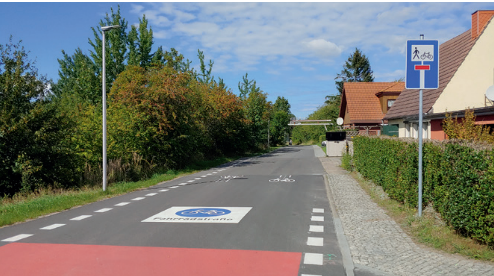
Bild 6: Netunterbrechungen für den Kfz-Verkehr – wie hier eine für den Fuß- und Radverkehr durchlässige Sackgasse – halten Durchgangs- und Schleichverkehr aus Fahrradstraßen wirksam heraus. (Foto: ©Tim Birkholz/AGFK MV)
