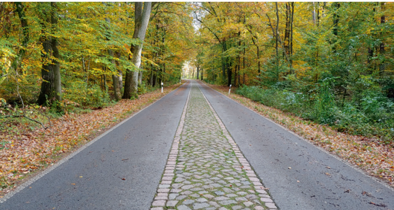
Bild 27: Auf außerörtlichen Fahrradstraßen kann eine bauliche Mitteltrennung die Kfz-Geschwindigkeiten reduzieren. (Foto: ©Tim Birkholz/AGFK MV)
