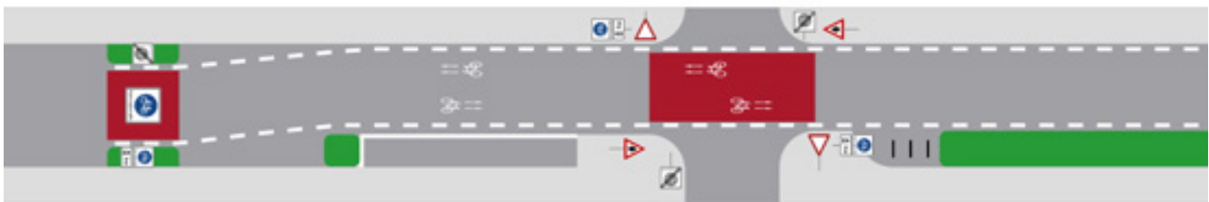
Bild 25: Beispiel für die Umgestaltung einer Erschließungsstraße zur Fahrradstraße mit einer Fahrgasse nach Standardbreite (Grafik: ©Innovative Städte)
