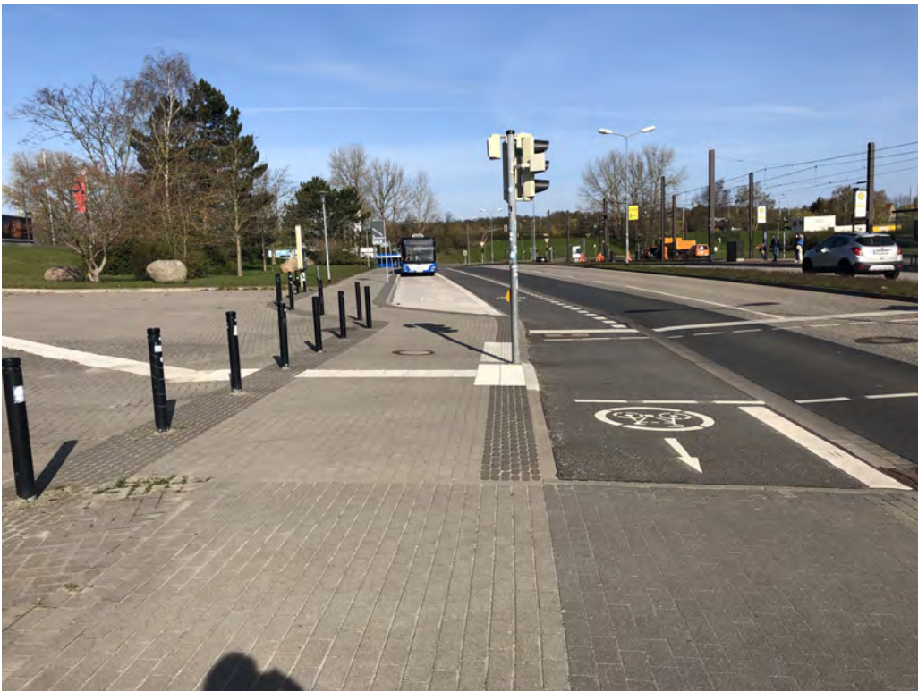
Fußgängerwartefläche hinter dem Radweg/ Poller in rauem und kontrastreichem Streifen
