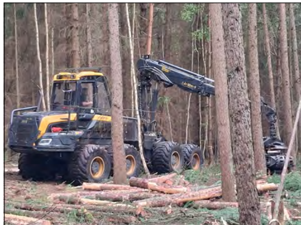
Abb. 25: Durchforstung von Nadelholzbeständen mit Harvester
