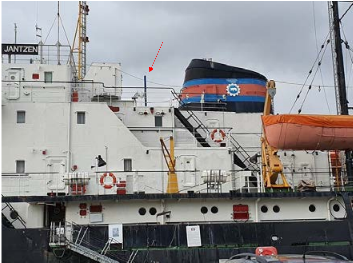
Abb. 3: Auf dem Eisbrecher „Stephan Jantzen“ installiertes Radargerät, hier mit vertikal rotierender Antenne (roter Pfeil).
