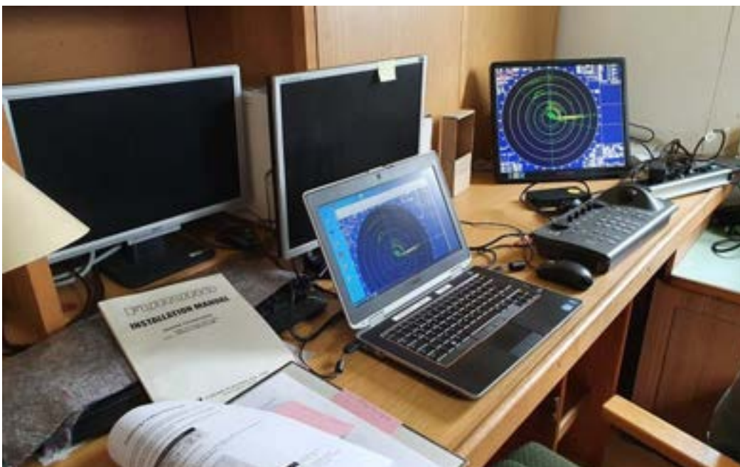
Abb. 5: Bedienungseinheit des Radargerätes mit Übertragung der Radarbilder auf einen Laptop an Bord des Eisbrechers „Stephan Jantzen“.
