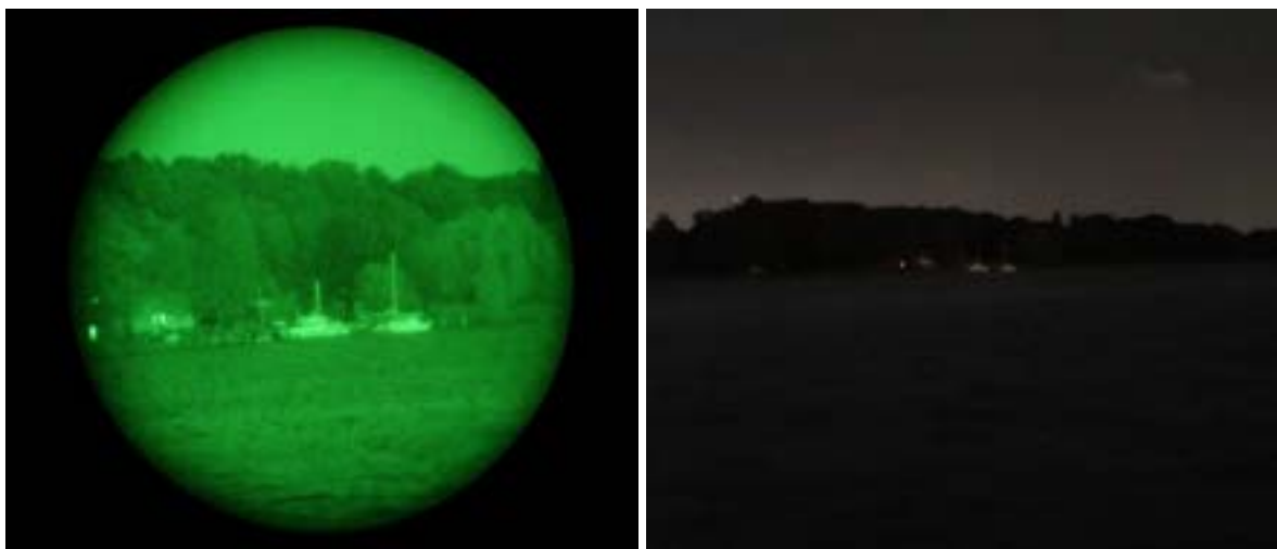
Abb. 13: Blick durch den für nächtliche Vogelerfassungen eingesetzten Restlichtverstärker des Typs Zeiss Victory NV 5,6 x 62 T* am Standort Warnowbrücke in Richtung Gehlsdorfer Ufer (links). Als Vergleich die Originalsituation ohne Nachtsichtoptik und Vergrößerung zum gleichen Zeitpunkt (rechts).
