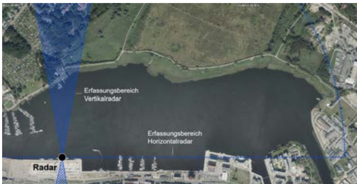
Abb. 2: Standort des Radargerätes im Rostocker Stadthafen mit Erfassungsbereichen im horizontalen und vertikalen Betrieb (schematisch; blau).
