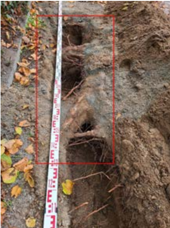
Abbildung 07: Fährberg, D-18147 Rostock. Rot markiert: Baumnummer 31 mit Schwach- und Grobwurzelanteilen in der Oberschicht. (BECKER, M., 09. NOVEMBER 2020).
