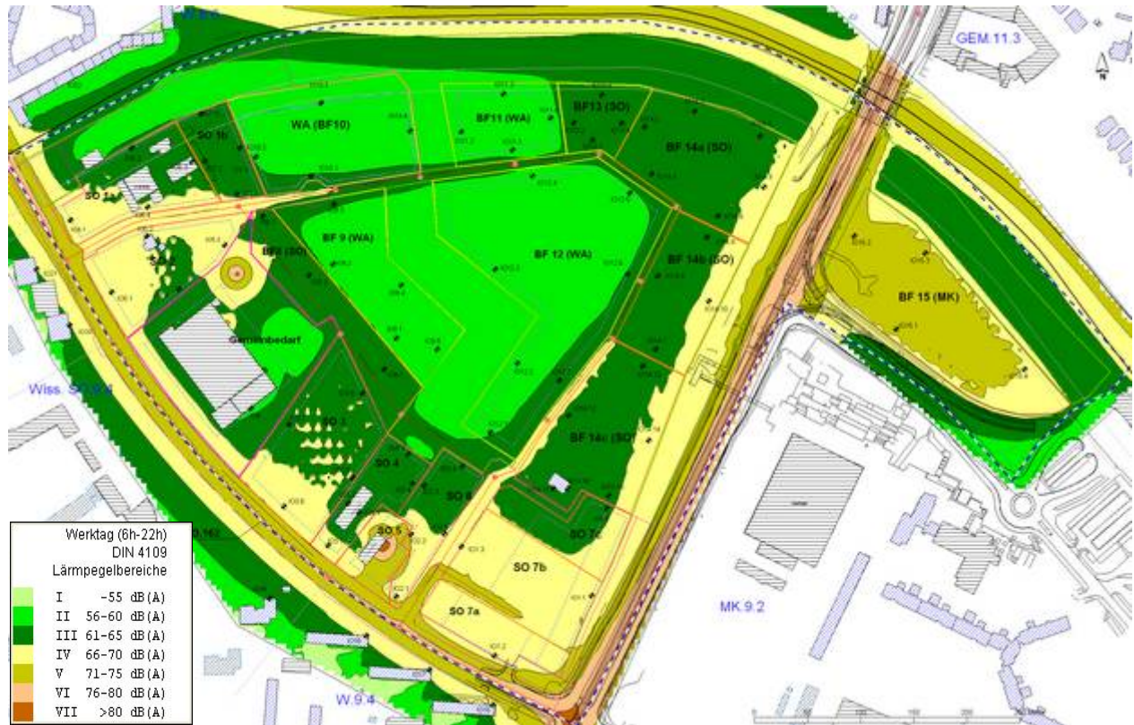
Abb. 8: maßgebliche Außenlärmpegel und Lärmpegelbereiche; Beurteilungszeitraum Tag
