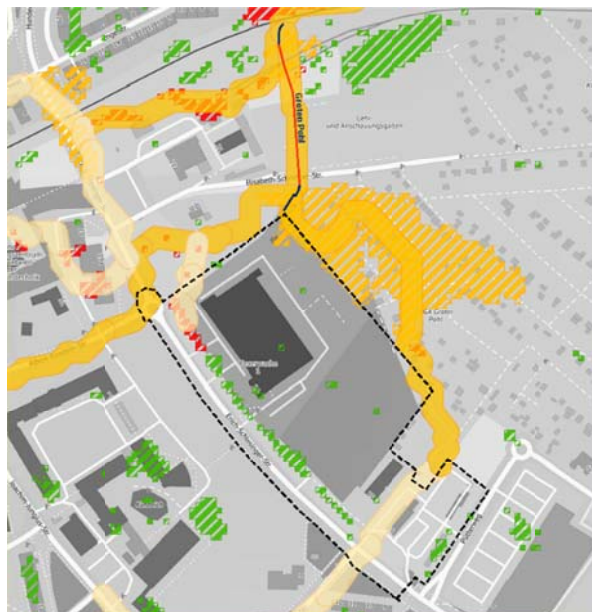
Abb. 7: Auszug INTEK - Gefährdung durch oberirdische Abflussbahnen und Senkenlagen
