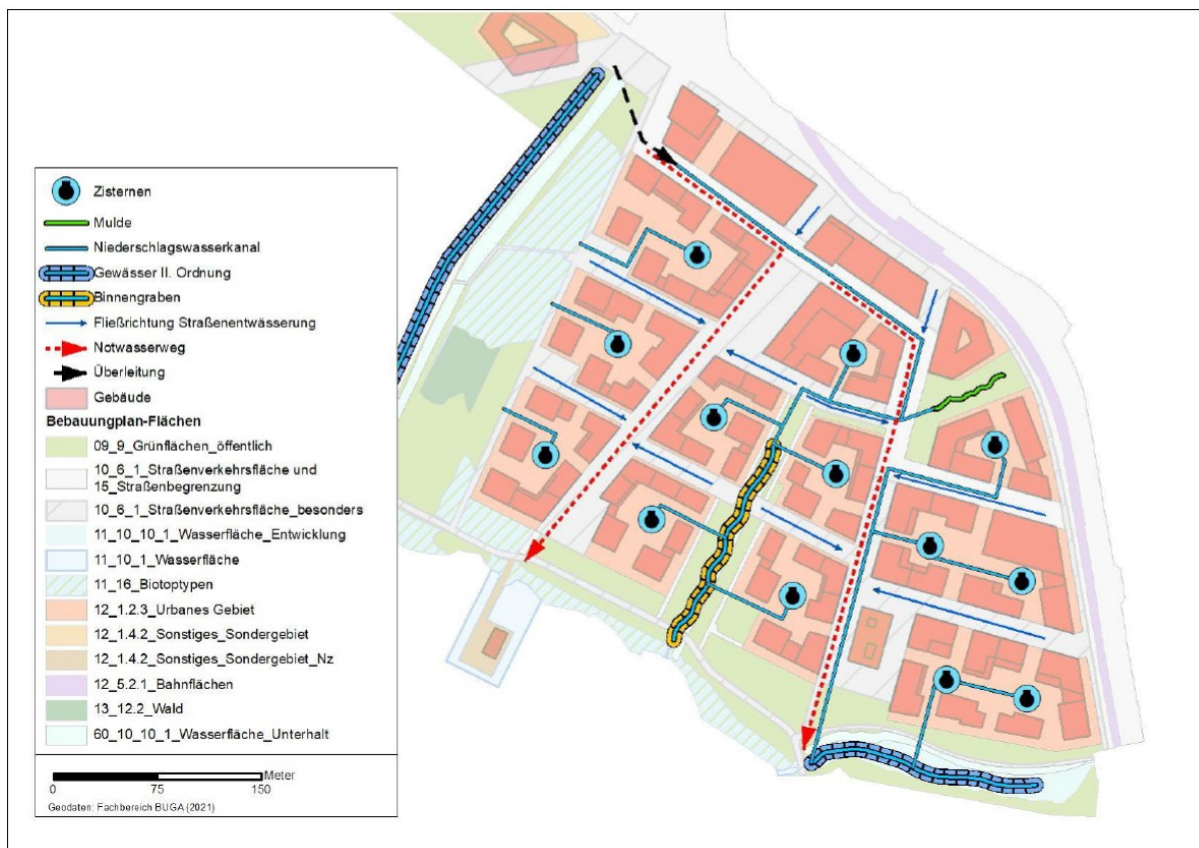
Abbildung 26: Schema des Entwässerungskonzept „Schwammstadt“ für den B-Plan Warnow-Quartier (Institut biota 2021, S. 77)
